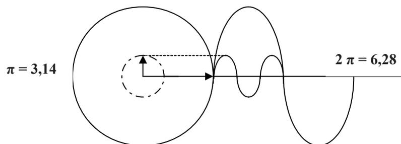
Der kleinere Radius ist nur ein Drittel von „Eins“ und bewegt sich deshalb auch drei Mal so schnell. Mit den anderen „ungeraden Radien“ ( $\dots + 1/5 \sin(5x) + 1/7 \text{SIN}(7x) + 1/9 \text{SIN}(9x) \dots$  usw.) verhält es sich dann genau so, ich habe sie der Übersichtlichkeit halber in dieser Zeichnung nicht berücksichtigt.
